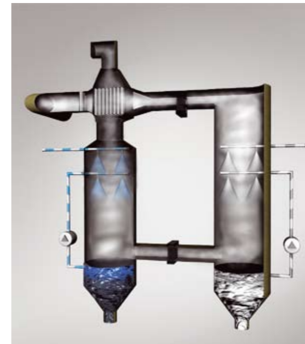
Schnittbild WÄSCHER Profile of WET SCRUBBER
